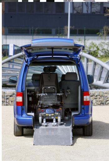
Toda a tecnologia instalada, foi concebida para utilização frequente. A zona para cadeira de rodas pode dispor opcionalmente, de proteções em aço inoxidável para prevenir o desgaste. O espaço para a cadeira de rodas é amplo. A rampa de acesso é construída em material compósito, muito leve e resistente, sendo também rebatível no pavimento, o que facilita em muito o acesso sem obstáculos, como zona de bagagem.
