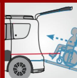
O revolucionário Guincho elétrico é um acessório opcional desenhado para este veículo, permitindo rebocar a cadeira de rodas para a rampa de acesso de forma confortável e segura.
